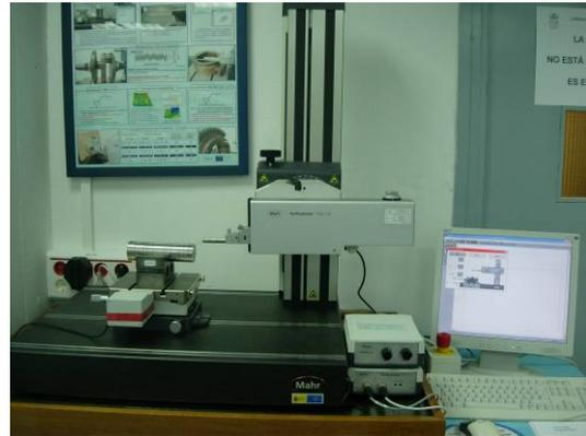
**Figura 2.** Rugosímetro PeCo T
