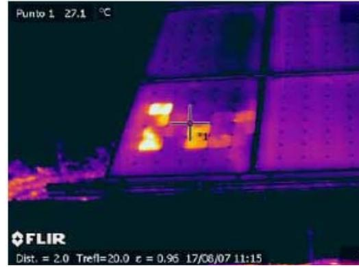
Figura 1. Módulo FV con células calientes.
