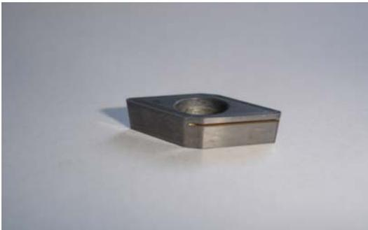
**Figura 2.** Detalle de ranura en la herramienta para inserción de termopar
