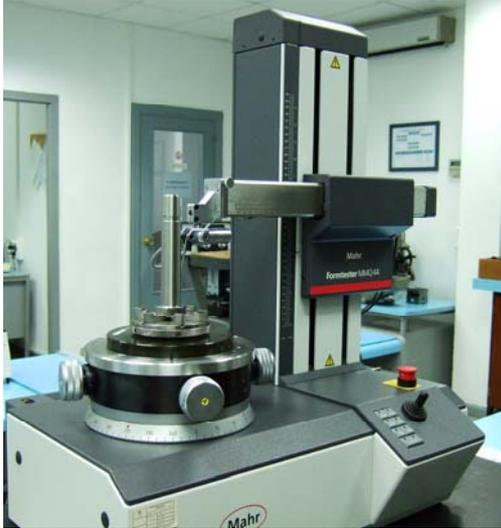
**Figura 2.** Pieza Tipo B03.R, colocada en la máquina MMQ 44 (Mahr).
