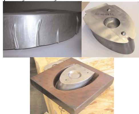
**Figura 3.** Arrugas en hidromoldadura, utillaje original y mejorado para aumentar la presión de la goma
