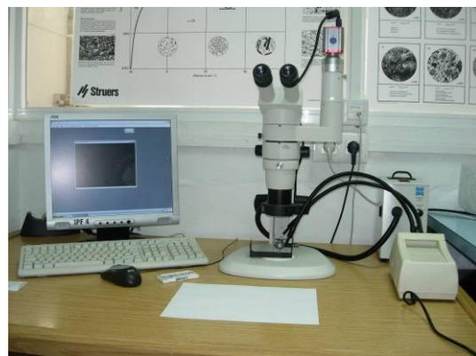
**Figura 3.** Microscopio óptico para primer análisis de viruta y herramientas
