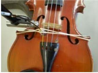
**Figura 3.** Instalación del acelerómetro en la tapa del violín
