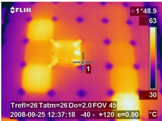
Figura 3. Módulo FV con célula sombreada.
