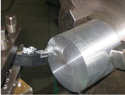
**Figura 1.** Instante de un Ensayo de Refrentado.
