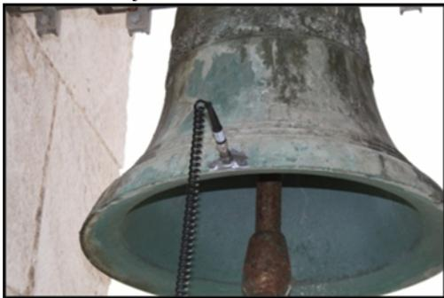
**Figura 4.** Colocación del acelerómetro en la boca de la campana
