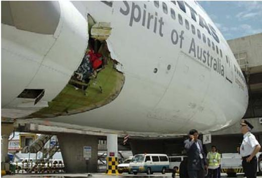
**Figura 2.** Efectos de la corrosión en un modelo de avión Boeing 747-438.
