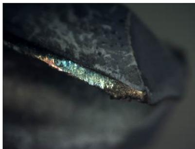
Figura 10. Adhesión sobre la cara de incidencia en el filo secundario ( $V_c=75\text{m/min}$ ,  $a=0,07\text{mm/rev}$ )
