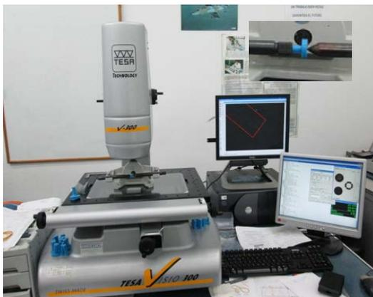
Figura 3. Máquina de medición sin contacto TESA Visio 300
