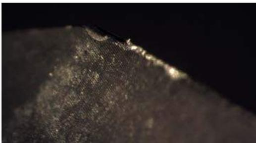
**Figura 2.** Microrotura en el filo de la herramienta.
