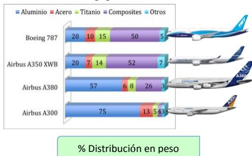
**Figura 3.** Evolución del uso de las aleaciones de titanio en la fabricación de aeronaves.
