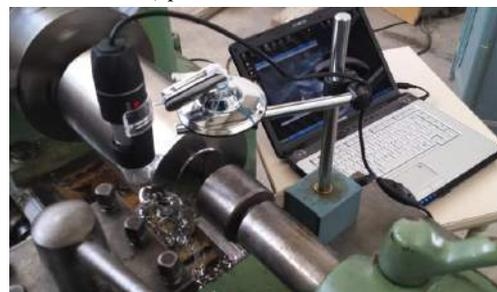
**Figura 8.** Montaje y preparación del ensayo de torneado
