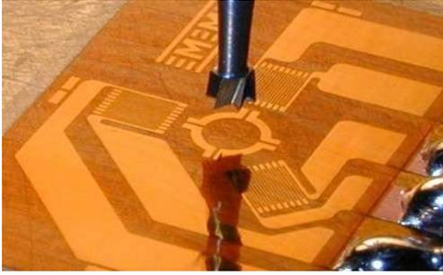
**Figura 5.** Adquisición de datos de tensiones residuales mediante “Hole Drilling”
