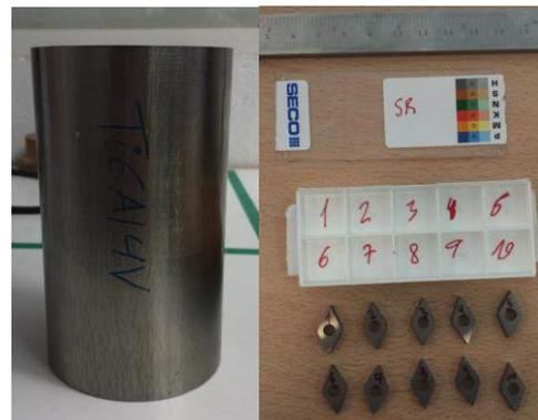
**Figura 7.** a) Probeta cilíndrica de UNS R56400; b) Plaquitas intercambiables de metal duro (WC-Co) para torneado
