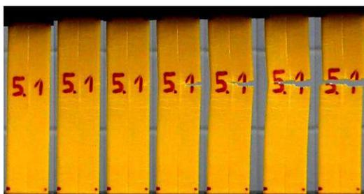
**Figura 7.** Grietas y “crazing” bajo tracción
