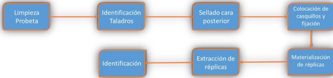
**Figura 2.** Esquema obtención réplicas de taladrado.
