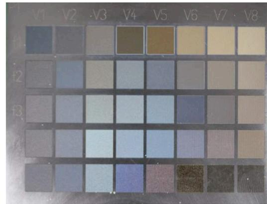
**Figura 2.** Probeta de Ti6Al4V tratadas con láser en atmósfera oxidativa
