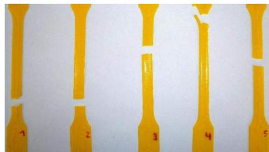
**Figura 2.** Rotura de probetas tipo hueso (Fused Layer Modeling)
