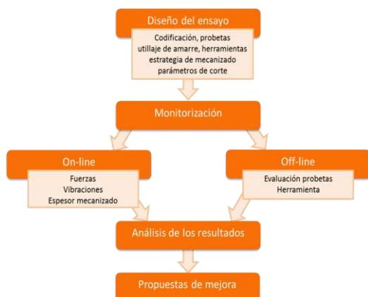
**Figura 1.** Diagrama de la metodología para el estudio del mecanizado de piezas.
